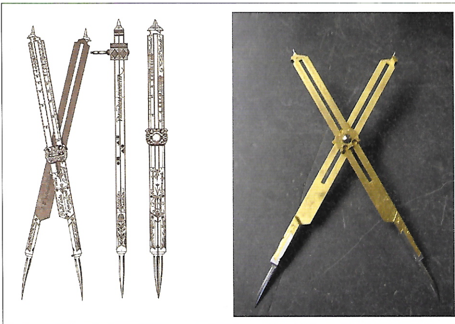
Abb. 3: Bürgis Proportional-Reduktionszirkel ist ein Doppelzirkel mit verschiebbarem Scheitelpunktknopf. Rechts: Replika-Exemplar von Bürgis Proportional-Reduktionszirkel aus Kassel; von Kern während 150 Jahren hergestellt.
