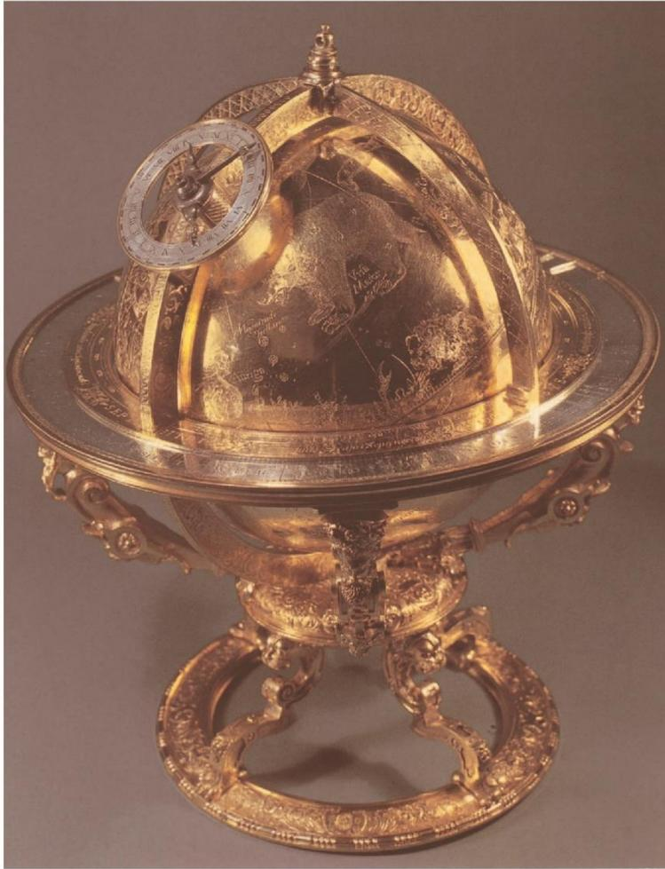
Mehrere Koordinatensysteme (Horizont-, Äquator- und Ekliptik-Koordinaten) erlauben, zusammen mit der automatischen Rotation der Kugel, die genaue gegenwärtige Position der Sterne und deren Konstellationen abzulesen und ermöglichen somit eine exakte Ausrichtung der Instrumente für die Himmelsbeobachtung. Meridian und Horizont bilden die Hauptachsen und ein mobiles Meridiansegment, das leider nicht erhalten ist, erleichterte mit einer Lupe die Lesung der Positionen.
