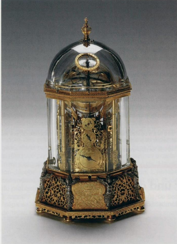
Jost Bürgis einzigartige Wiener Bergkristalluhr, gefertigt von ihm 1622/27 in seiner Werkstatt auf dem Hradschin in Prag. Ausgestattet mit Sekundenanzeige, Mondzifferblatt, Miniaturglobus und Kreuzschlaghemmung.
