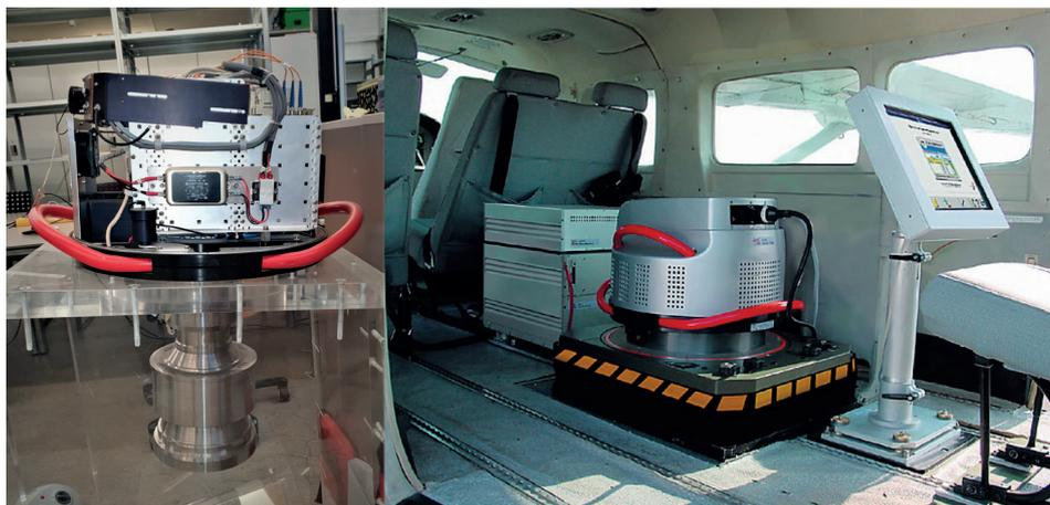
Abbildung 5-8: Digitalkamera Leica ADS40 im Labor und auf kreiselstabilisierter Plattform im Flugeinsatz
