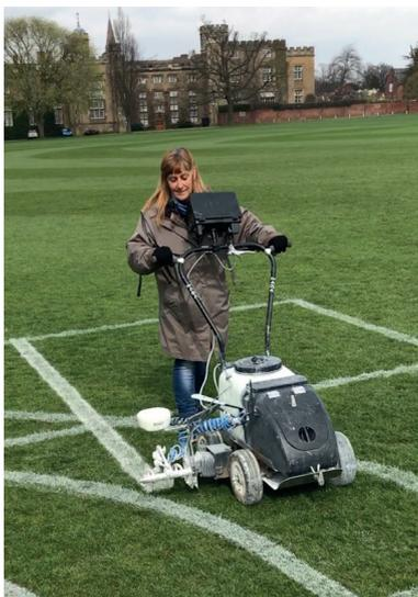
Abbildung 5-10: GNSS gesteuertes Markieren von Linien auf Sportplätzen
