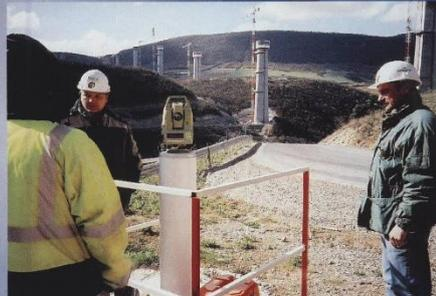
Bau des Viaduc de Millau 2003 mit Lasertheodolit.
