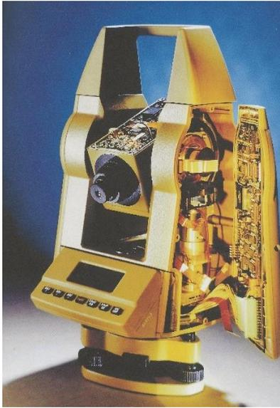
*Der elektronische Tachymeter Leica TC500 von Leica Geosystems Heerbrugg aus dem Jahre 1998 vereint den klassischen Wild-Theodolit-Aufbau mit integriertem Laser sowie Anwender-Software.*
