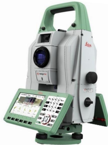
*Die «Multistation» MS60 von Leica Geosystems Heerbrugg aus dem Jahre 2023 kombiniert Heinrich Wilds Theodolit-Aufbau mit aus Einsteins Theorie entwickeltem Laser zweifach: einmal zur hochpräzisen Streckenmessung wie bei einer Totalstation und darüber hinaus mit einer LaserScan-Funktion zur Erfassung, Messung, Auswertung und Dokumentation millimetergenauer 3-D-Laserpunktewolken.*
